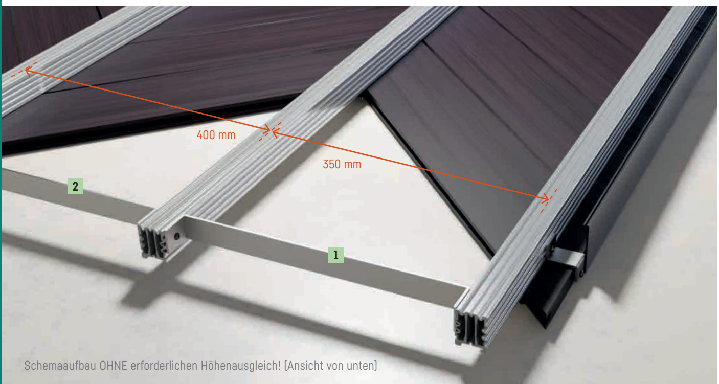
Schemaaufbau OHNE erforderlichen Höhenausgleich!
